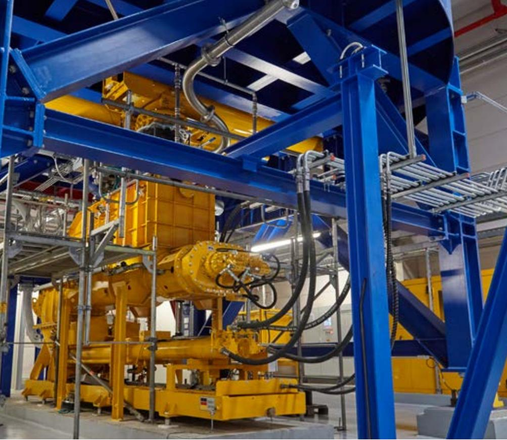
Vom Speichersilo aus wird direkt der ca. 60 m entfernte Wirbelschichtofen beschickt. Die Fördermenge wird in Abhängigkeit der max. möglichen Zugabeleistung individuell an den Prozess angepasst und schwankt zwischen 20 und 30 m<sup>3</sup>/h.
